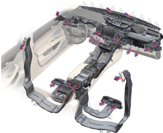
Bild 1: Luftführung einer 4-Zonen-Fahrzeugklimatisierung.
